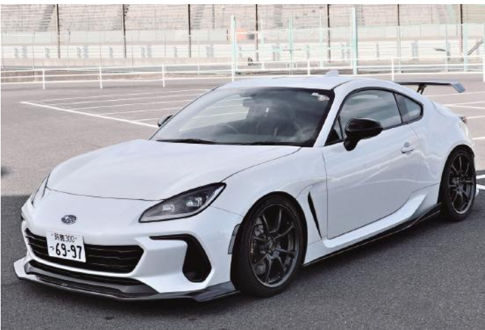
■ホイール/RAYS NE24 ■タイヤ/YOKOHAMA NEOVA AD09 245/35-18inch ■ブレーキ/九州男児商会
