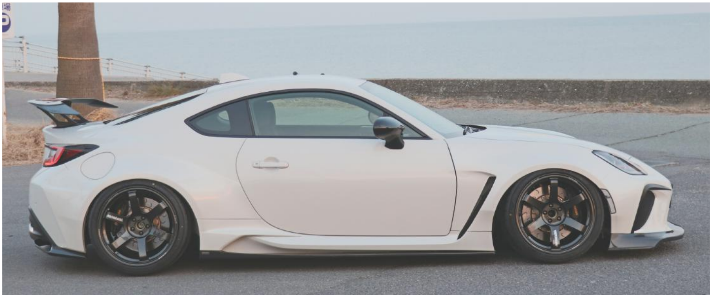
サイドアンダー →純正サイドをベースに製品コストを抑えながら違和感が出ない様にワイドフェンダーと融合するようにデザインしました。機能的にもリヤタイヤ前を整流するディフレクター効果が出るようにしてあります。
